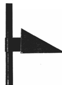
Belysning Adkomstgater: Armaturlamp BEGA 8071, montert på kon mast, farge sort RAL 9004.
